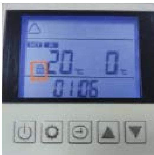
Klicken Sie im gesperrten Status auf eine beliebige Taste, um den Bildschirm zu beleuchten. Nachdem Sie die Taste „ON / OFF“ 5 Sekunden lang gedrückt gehalten haben, ertönt der Summer „Diii“, die Steuerung wird entsperrt und das Symbol „Schlossschlüssel“ erlischt.
