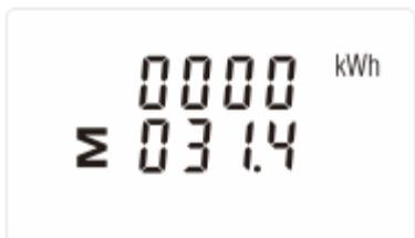
Hier wird die Gesamt-Wirkleistung [kWh] angezeigt.(0000 031,4kWh)
