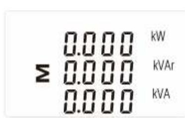
Hier werden die Gesamtwerte der Wirkleistung [kW], der Blindleistung [kVAr] und die Scheinleistung [kVA] angezeigt.
