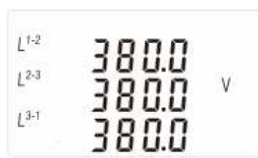
Hier werden die aktuellen Spannungen [V] zwischen den Phasen und dem Neutralleiter (3p3w) angezeigt.
