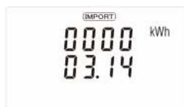
Hier wird die aufgenommene Wirkleistung [kWh] phasenbezogen angezeigt.
