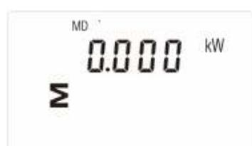
► Um zur Anzeige der Frequenz und des Leistungsfaktors zu wechseln, drücken Sie die Taste „M“.
