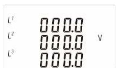
Hier werden die aktuellen Spannungen [V] zwischen den Phasen und dem Neutralleiter (3p4w) angezeigt.
