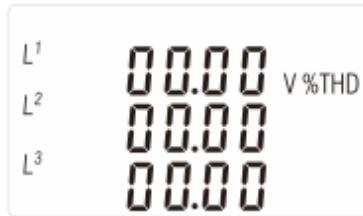
Hier wird die harmonische Spannungsverzerrung zwischen den Phasen und dem Neutralleiter [%] angezeigt.
