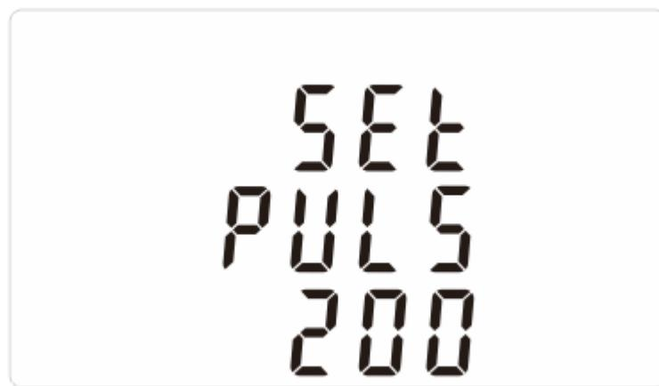
► Drücken Sie etwa eine Sekunde lang die Taste „E“. Die Anzeige der eingestellten Impulsdauer blinkt.
