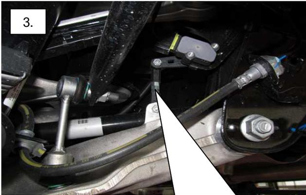
Eibach Regelstangen auf die Länge der Serien-Regelstangen einstellen, montieren und mit den serienmäßigen Muttern verschrauben.
