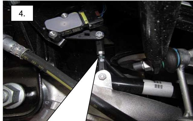
Fahrzeug gegen wegrollen sichern und Motor starten. Eibach Regelstange über die Einstellschraube soweit zusammendrehen (1 Umdrehung ca. 8mm) bis der Höhenstand lt. Teilegutachten Seite 10, Punkt IV.6 erreicht wird. Beide Seiten der Eibach Regelstange kontern.
