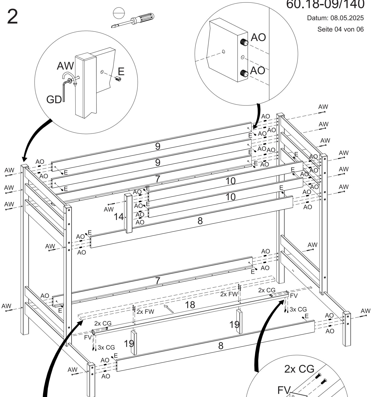
**DE** Beim Einsatz eines Bettkastens wird die Mittelleiste in die hintere Position gebracht.
