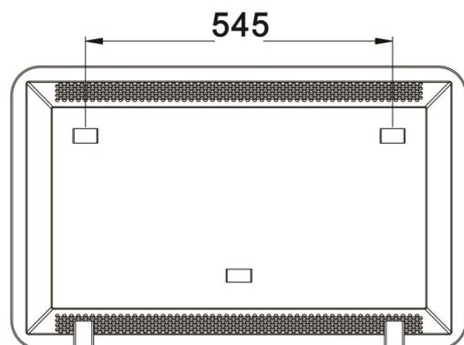
Das Gerät kann auch an einer Wand montiert werden. Nutzen Sie hierfür die gezeigten Abstände für Bohrungen.
