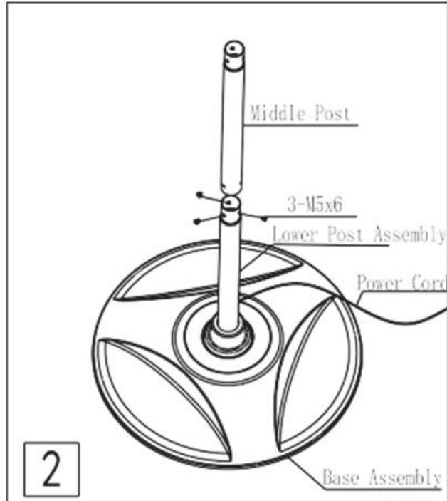
Verbinden Sie die obere Pfostenbaugruppe (7) und den mittleren Pfosten (9) mit 3 M5X6-Schrauben
