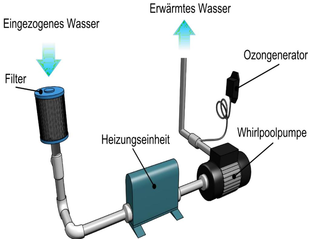
In dem verwendeten Whirlpool-System schalten sich während der Filterung der Ozongenerator und der Massagemotor mit niedriger Geschwindigkeit ein. Dies dient dazu, die Rohre zu reinigen und eine gute Wasserqualität zu sichern.
