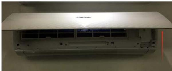
1.2 Schrauben der WiFi-Box lösen. Die Standorte der WiFi-Boxen können je nach Klimaanlagentyp unterschiedlich sein.
