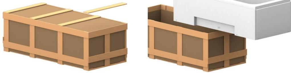
Sollte die Ware unten verschraubt worden sein, heben Sie das gesamte Holzgestell nach oben und legen Sie es zur Seite. Der Pool kann nun von der Bodenplatte gehoben werden.
