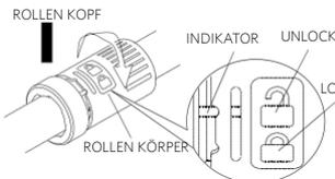
Greifen Sie den Rollenkörper und Rollenkopf und drehen in die entriegelte Position.
