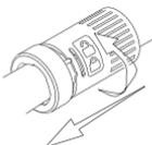
Schieben Sie die Walze in die gewünschte Position und drehen, bis er einrastet.
