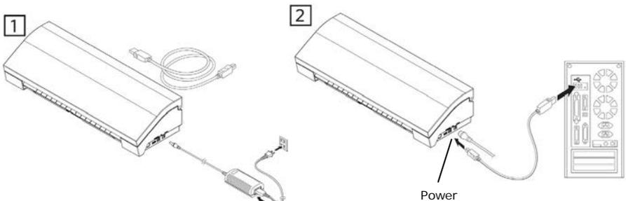
Schalten Sie das Gerät an indem Sie den Netzschalter drücken. Folgen Sie den Touchscreen Anweisungen, um Ihre Sprache zu wählen und die Ersteinrichtung durchzuführen. Wenn Ihr PC ein Dialogfeld "Neue Hardware gefunden" anzeigt, folgen Sie den Anweisungen zur Treiber Installation.
