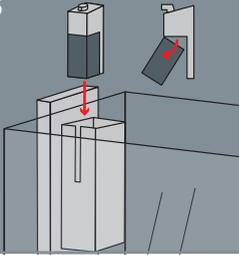
Lees eerst de Aqua-Flow gebruiksaanwijzing. Installeer vervolgens het AquaFlow filter in het filtercompartiment en werk de kabel weg achter het zijpaneel. Het filter zorgt ervoor dat het water gezond blijft, daarvoor moet de filtercassette wel wekelijks schoongespoeld worden. Klik de cassette van het filter en spoel deze af met schoon kraanwater. De cassette bevat kool wat schadelijke stoffen uit het water absorbeert, vervang de cassette maandelijks voor een goede werking.
