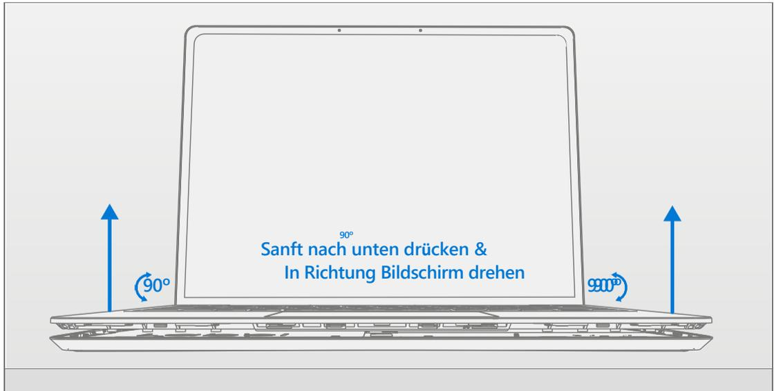
3. **FPCs trennen** – Heben Sie bei gedrehter Tastatur in Richtung des Bildschirms die Steckerverriegelung am Akku-FPC an und ziehen Sie dann den FPC heraus. Heben Sie als Nächstes die Steckerverriegelung an der Tastatur-FPC an und ziehen Sie dann die FPC heraus.
