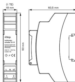
Der Leistungsschalter S1-R behält seine Schaltstellung im stromlosen Zustand bei. Die Schaltstellung ist bei Auslieferung unbestimmt, d.h. der Schaltausgang kann leitend mit der Phase L verbunden sein! Bei der Installation sind die allgemeinen Gefahren im Umgang mit Hausspannungsnetzen zu beachten!
