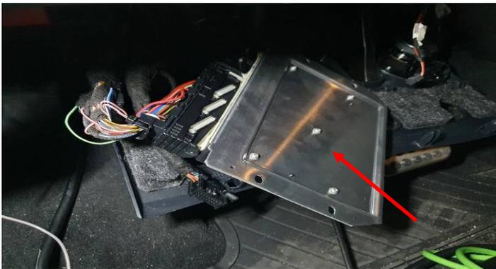
Wir empfehlen das Steuergerät aus der Halterung (geclipped) zu nehmen, damit der Rest vom Einbau einfacher vonstatten geht.
