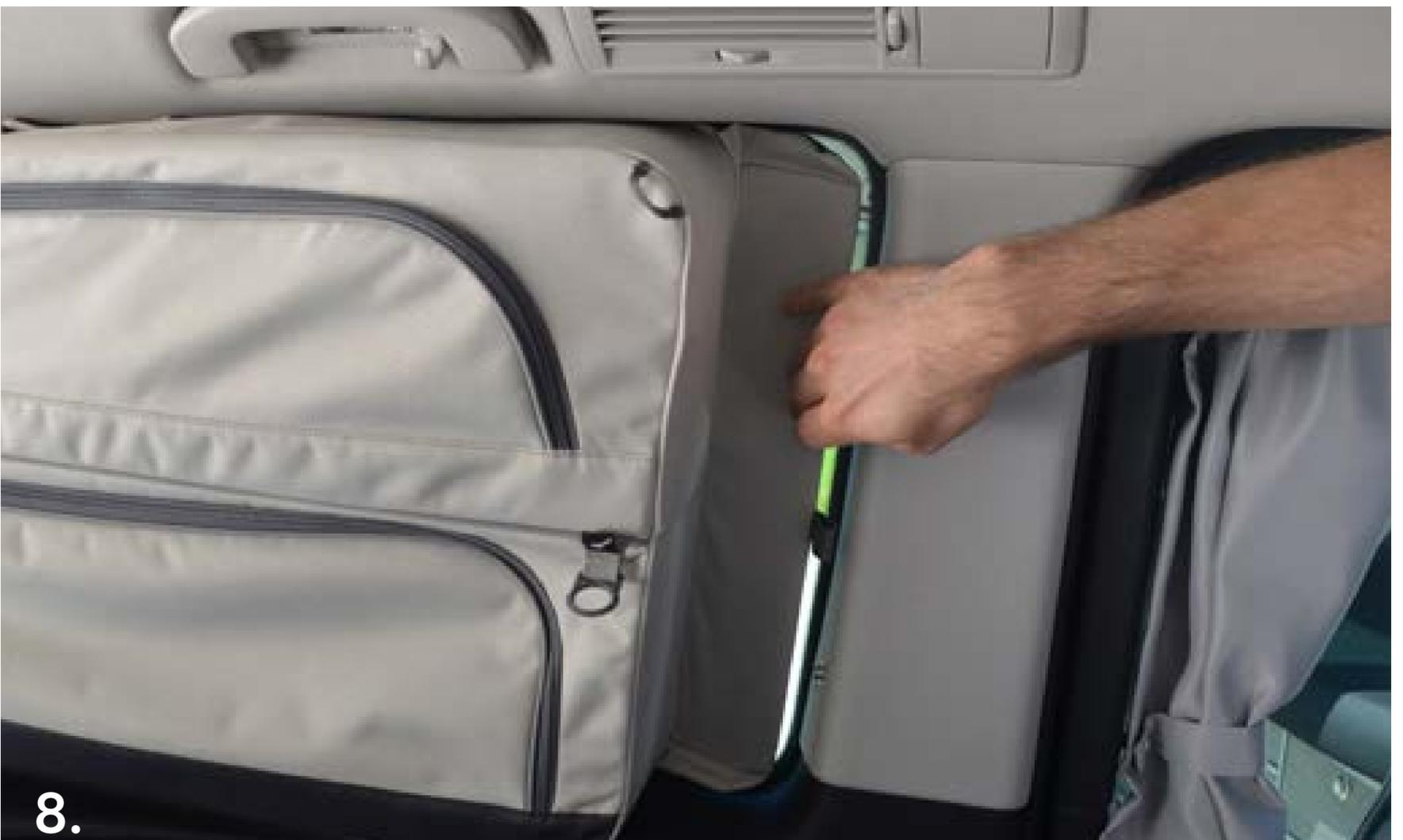
Klappe anschließend die Lasche nach hinten ans Fenster und drücke diese so an, dass sie hinter der Gummilippe Halt findet (Bild 8).
