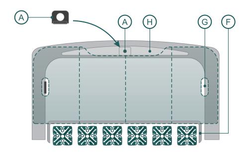
Die Grifflöcher (G) dienen zum Öffnen des Schlafboards und, bei manuellen Dächern, gleichzeitig zur Aufnahme der Auflagepuffer des Aufstelldachs.
