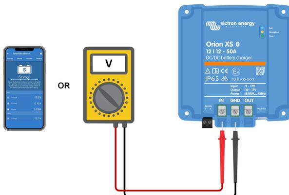
2. Messen Sie die Batteriespannung an den Klemmen der Batterie mit einem Multimeter.
