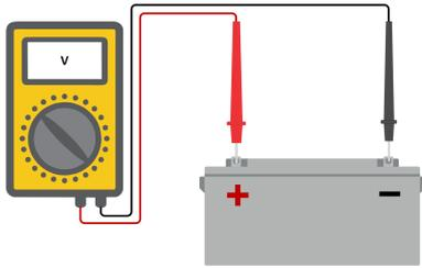
3. Vergleichen Sie die beiden Spannungen, um festzustellen, ob ein Spannungsunterschied besteht.
