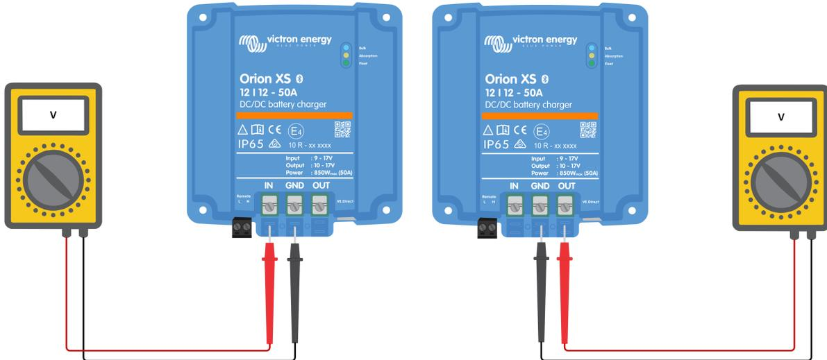
Die Messung der Batteriespannung an den Klemmen des Ladegeräts dient dazu, mögliche Probleme mit der Verkabelung, den Sicherungen und/oder Stromkreisunterbrechern in der Verbindung zwischen der Batterie und dem Ladegerät auszuschließen.
