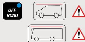
Mit der Taste
