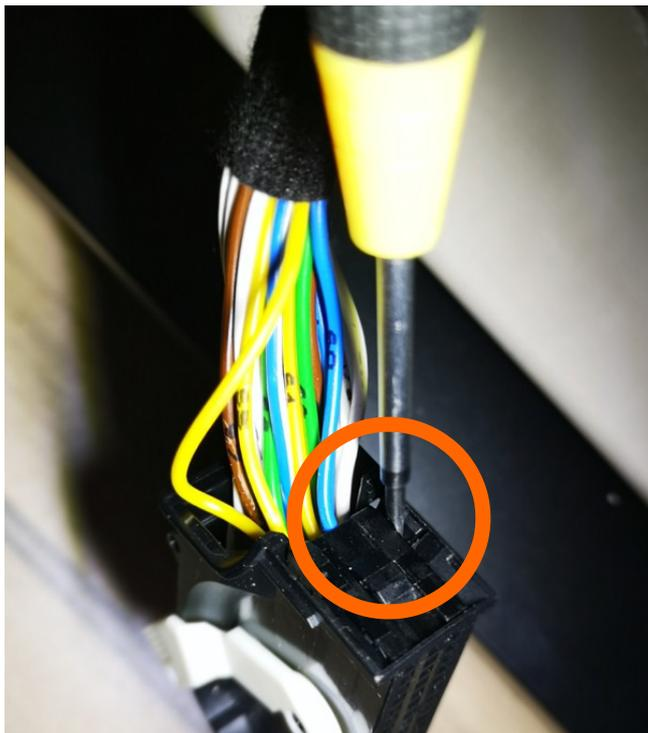
**Entriegeln Sie das Steckergehäuse.**
