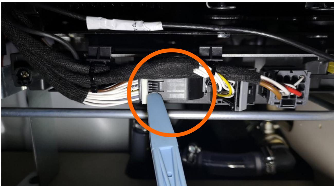
**Entriegel und entfernen Sie den 54-poligen Stecker.**
