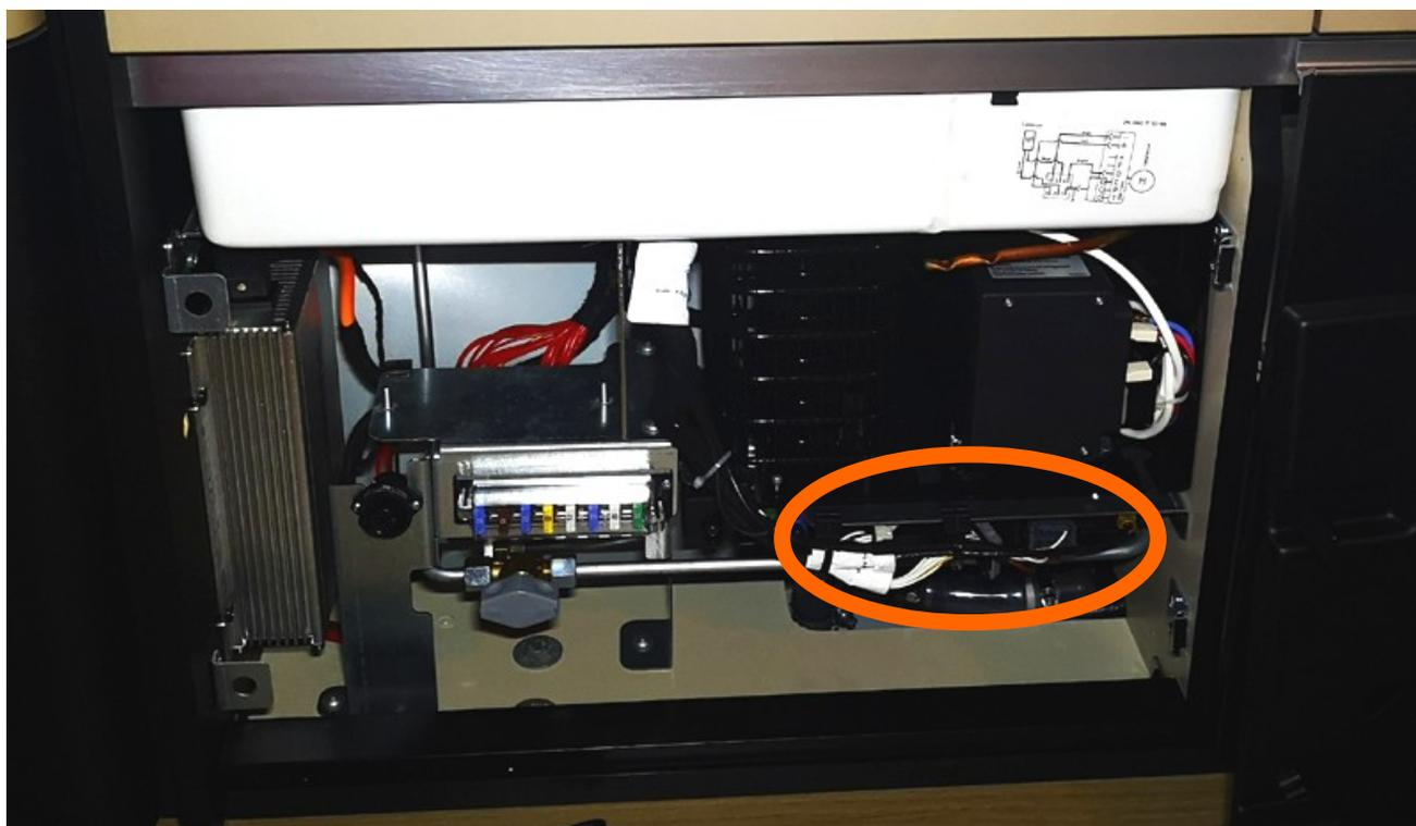
**Nehmen Sie die Verkleidung ab. Das Steuergerät befindet sich unter dem Kompressor.**
