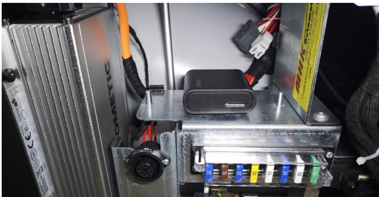
**Schließen Sie den schwarzen, 14-poligen Stecker des DANHAG-Leitungssatz an die APP-Steuerung an. Befestigen Sie die APP-Steuerung mit dem beiliegenden Klettband.**
