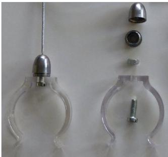
Damit später die M4 Schraube die Leuchte nicht zerkratzt bitte die Schraube von innen in der Klammer einsetzen. Dann die Hülse mit Innengewinde aufsetzen. Nun die M4 Mutter verschrauben. Nicht vergessen! Nun das Seil durch die DOM-Kappe mit Innengewinde ziehen. Das Seil hat ein Ende mit einer Verdickung die nicht durch die Dom Kappe passt.
