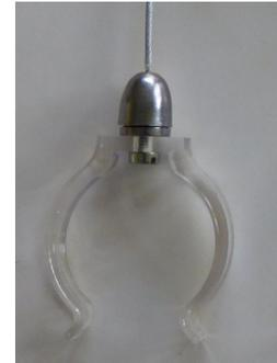
Jetzt die DOM-Kappe aufsetzen und festdrehen. Nun das Seil mit dem anderen Ende durch den Fixierungs Einsatz drücken. Dieser Fixierungseinsatz ist einstellbar, um später die Lampe auszurichten. Das funktioniert so: Man nehme einen kleinen Schraubendreher und drücke auf den herausstehenden Seilaufnahme Pin. Mit dem drücken wird die Haltemechanik gelöst und das Seil lässt sich verstellen.
