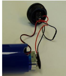
Wenn Sie die Endkappe mit Schalter vom Griff entfernt haben, sehen Sie die Kabel und den Batterie Klips zum Aufstecken der 9 Volt Block Batterie.
