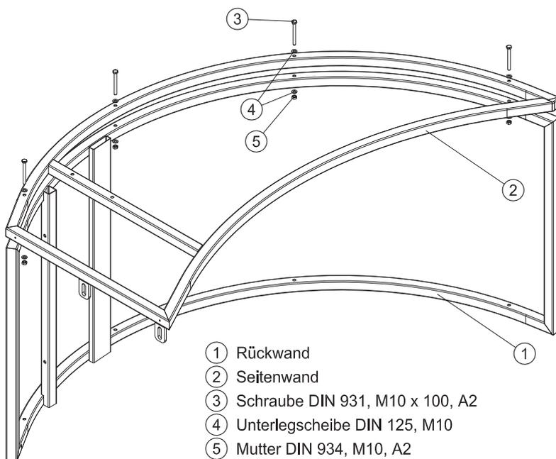
Erste Rück- und Seitenwand ① aufstellen und die nächsten zwei Rückwände ② + ③ sowie Seitenwand ④ anfügen und fest miteinander verschrauben.
