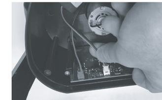
Öffnen Sie die Abdeckung unter dem Touchscreen, indem Sie die drei Schrauben lösen.
