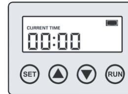
8. Drücken Sie SET so lange bis die Timereinstellung angezeigt wird.
