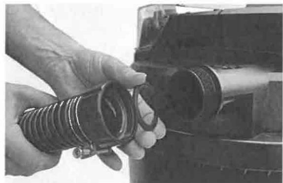
**Schritt 9** - Bringen Sie erneut alle Schläuche an - Denken Sie daran, die Flachdichtungen einzuführen und die Sicherungsmuttern festzuziehen.
