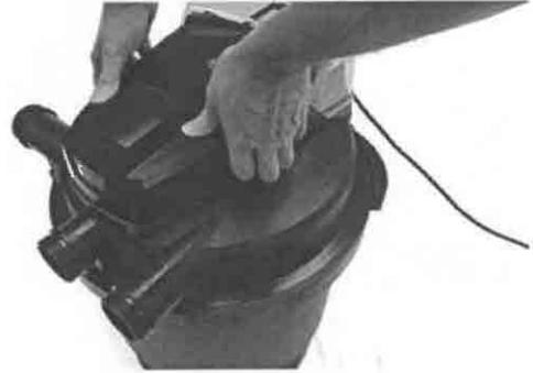
**Schritt 2** - Ziehen Sie das UV-Gerät heraus, indem Sie mit den Daumen auf den Deckel drücken und ihn mit den Fingern unter dem Gerät anheben.
