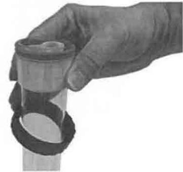
**Schritt 6** - Überprüfen Sie die Quarzglas-Röhre und wechseln Sie sie aus, falls Sie kaputt sein sollte. Überprüfen Sie, ob alle O-Ringe vorhanden sind und schmieren Sie sie mit Silikonfett.
