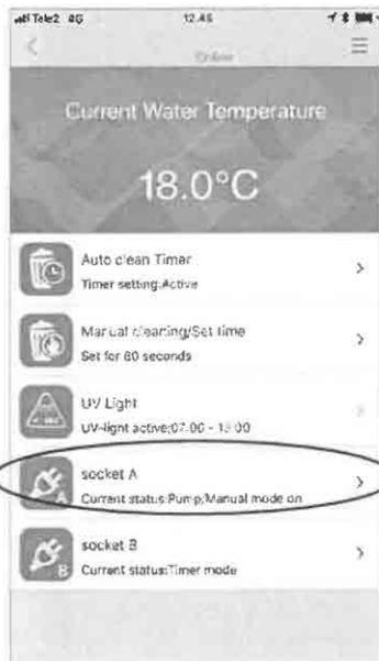
25. Steckdose A ist für die Pumpe reserviert, die den Filter versorgt! Dadurch wird für Sicherheit und Funktionalität gesorgt. Max. 800W Gesamtleistung für A+B
