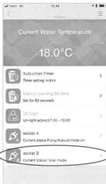
28. Steckdose B kann für alle Teich-Geräte wie die Zufuhr, die Dosierungspumpe und das Licht verwendet werden. Max. 800W Gesamtleistung für A+B
