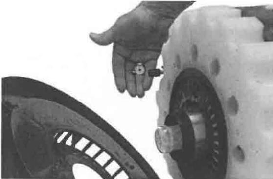
**Schritt 5** - Achten Sie darauf, die Kunststofflager auf der Schaumseite der Platte nicht zu lösen, wenn Sie die Grundplatte entfernen.
