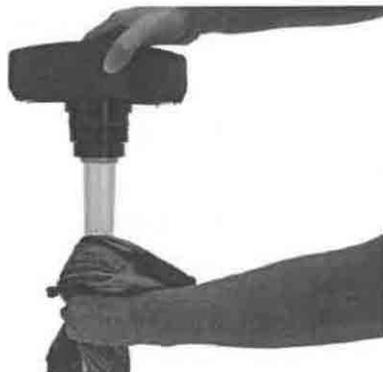
**Schritt 3** - Reinigen Sie die Quarzglas-Röhre mit einem feuchten Tuch und trocknen Sie sie ab.
