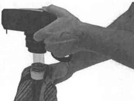
**Schritt 5** - Ziehen Sie die Quarzglas-Röhre heraus, woraufhin Sie die UV-Lampe herausziehen und ersetzen können.
