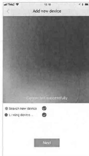
11. Falls Ihr Netzwerksignal in Ordnung und bei 2.4 Ghz ist, hört die Wi-Fi-LED auf zu blinken und leuchtet durchgehend. Nachdem die Verbindung aufgebaut ist, drücken Sie auf „Weiter“ („Next“).
