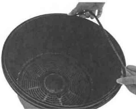
**Schritt 8** - Passen Sie den O-Ring oben am Kanister ein. (um das Einsetzen des Deckels zu erleichtern, können Sie (nach Möglichkeit) Silikonfett verwenden, oder den O-Ring befeuchten.) Der Deckel kann dann reingedrückt werden und die große Klemme von der Scharnierseite aus befestigt und verriegelt werden.
