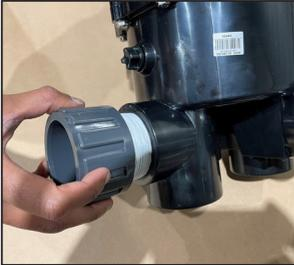
Schraubfiting in das Mehrwegeventil einschrauben.
