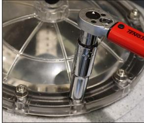
Alle 12 Muttern (M8) vorsichtig mit einem Drehmomentschlüssel lösen und die Unterlegscheiben entfernen. Sicher aufbewahren.
