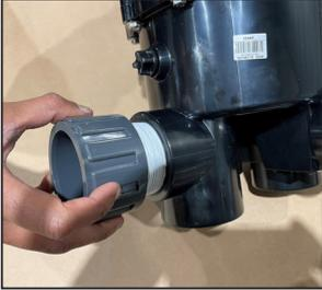
Schraubfitting in das Mehrwegeventil einschrauben.
