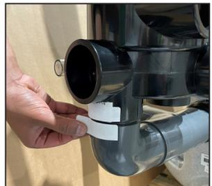
Zwei Stücke Abdeckband mit den Verbindungsstellen von Mehrwegeventilauslass und Anschlussrohr bündig aufkleben.
