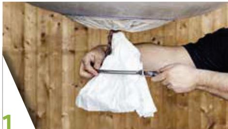
1 Den ersten Knoten des Big Bag-Auslaufs öffnen, sodass sich der Spannring auf den abstehenden Auslaufschlauch schieben lässt.
