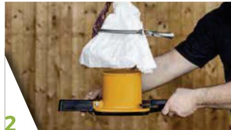
2 Den FLEDBAG® Easy von unten auf dem Auslaufschlauch positionieren.
