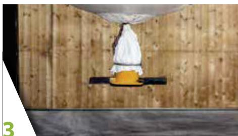
3 Den Spannring nach unten ziehen und den Spannring mit dem Auslaufschlauch am FLEDBAG® Easy fixieren.
