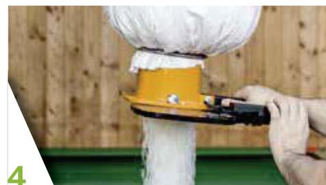
4 Zweiten Knoten des Auslaufs öffnen, sodass der Inhalt in den FLEDBAG® Easy einlaufen kann. Zur Entleerung den Schieber öffnen.
