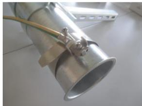
Anbringung der Erdungsschelle an dem Befüllrohr
