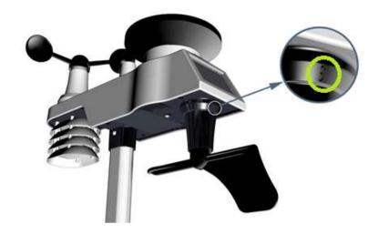
Befestigen Sie die Sende-Einheit in der Fußbefestigung mit Hilfe von zwei Ø3-Schrauben und M3-Muttern und dem Mast, wie in der Abbildung unten dargestellt:
