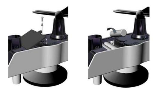
• **HINWEIS:** Setzen Sie die Batterien nicht rückwärts ein. Sie können die Sensoren dauerhaft beschädigen. Das Solarpanel lädt die Batterien nicht auf, daher werden wiederaufladbare Batterien weder benötigt noch empfohlen.
