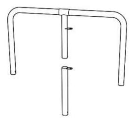
2 – Befestigen Sie die Rohre mit den Bolzen an den Sockeln
