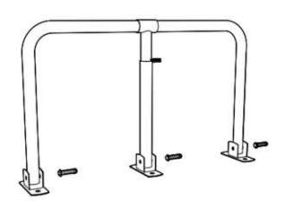
3 - Befestigen Sie die Sockel mit den mitgelieferten Ankern am Boden
