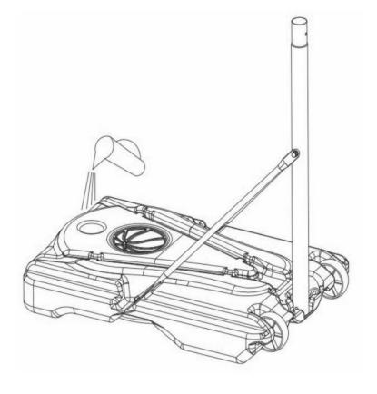
4. Befestigen Sie das Rohr 3 (Teil 3) am Unterrohr 4 (Teil 4) mit der M8X55mm (Teil 14) Schraube 1 St., M8 Unterlegscheibe 2 St. und M8 Mutter 1 St.
