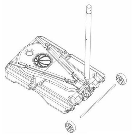
Befestigen Sie die Klammer L(Teil 8) und die Klammer R(Teil 8) an der Basis (Teil 5), unter Verwendung der M8X20mm (Teil 16) Schraube 2 Stück, M8 Unterlegscheibe 4 Stück und M8 Mutter 2 Stück. Befestigen Sie die Halterung L(Teil 8) und die Halterung R(Teil 8) am Rohr 4(Teil 4) unter Verwendung der M8X60mm (Teil 15) Schraube 1Stk, M8 Unterlegscheibe 2Stk und M8 Mutter 1Stk.
