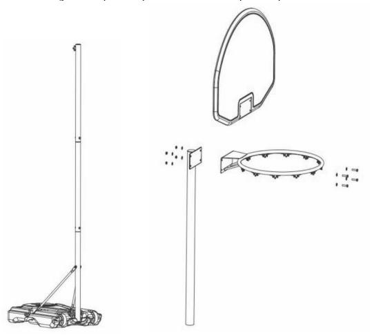
7. Verbinden Sie das obere Rohr 1 (Teil 1) mit dem Rohr 2 (Teil 2), mit der Stellschraube (Teil 12) 1 Stck.
