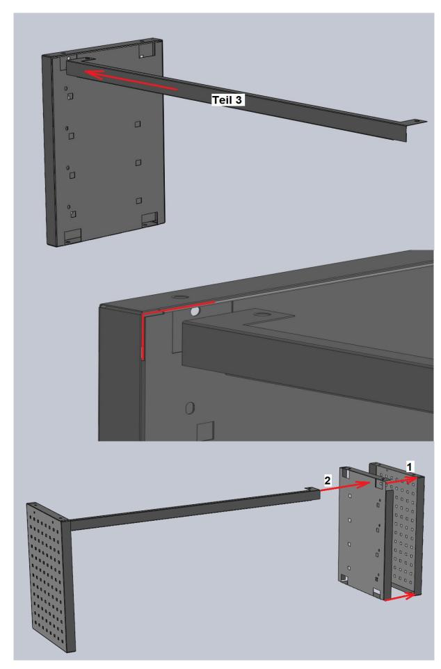
• Setzen Sie das obere Element auf das Untere und befestigen Sie es mit den M8x16 Schrauben.
