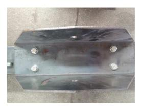
Verwenden Sie nun den Einstellhebel, Unterlegscheiben, Mutter und Sechskantschraube (M16X160 mm) um das Gehäuse (35) mit Schwenkvorrichtung (22) auf dem Ständer (3) zu befestigen.
