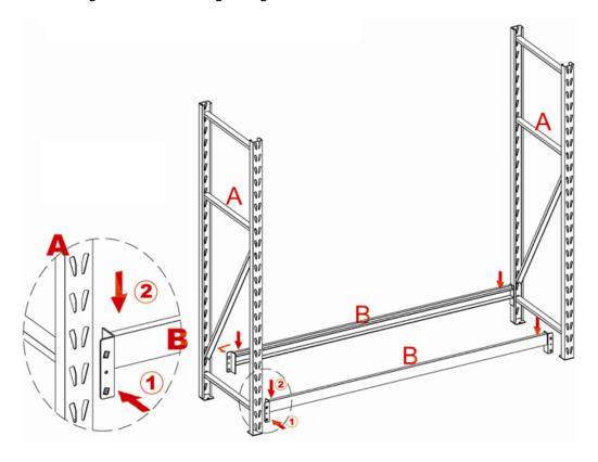
Montieren Sie auf die gleiche Weise die weiteren Traversen zwischen den Rahmenteilen (A).
