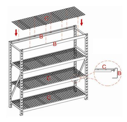
• Um eine bessere Stabilität zu gewährleisten, sollten Sie in die runden Öffnungen zwischen den beiden viereckigen Öffnungen der Traverse einen Sicherheitsbolzen (nicht im Lieferumfang enthalten) stecken.
