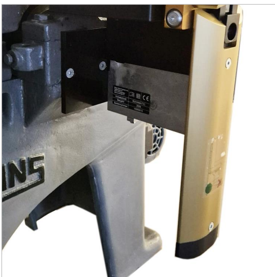
Über Adapterplatte montierter SUVAMATIC | SUVAMATIC mounted via adapter plate
