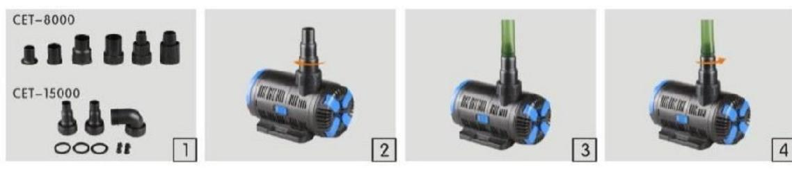
Die Pumpe ist mit einer Stufentülle ausgestattet. Bitte wählen Sie die gewünschte Schlauchgröße. Lockern Sie die Überwurfmutter, befestigen Sie den Schlauch und drehen Sie die Überwurfmutter wieder fest
