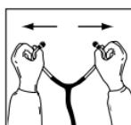
Para reducir la tensión del resorte en el auricular, tire de los tubos de los oídos. Repita hasta lograr la tensión deseada.
