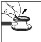
For å fjerne Littmanns fleksible membran, klem til på kanten av membranen med neglene til tommelen og pekefingeren. Trekk og løft membranen av stetoskophodet.
