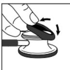
Para montar la goma quitafrío, coloque una parte de la funda en el borde de la pieza torácica y estírela sobre y alrededor del borde de la misma.
