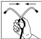
Pentru a crește tensiunea arcului în căști, apropiți tuburile de urechi. Repetați operațiunea până când se va obține tensiunea dorită.
