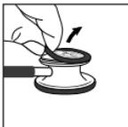
Para retirar la membrana de doble frecuencia Littmann, pellizque el aro de la membrana con las uñas de sus dedos índice y pulgar, tire y levante la membrana de la pieza torácica.
