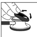
Aby zmontować „ciepłą” obwódkę lejka, należy umieścić jedną stronę obwódki na krawędzi głowicy i rozciągnąć ją po krawędzi głowicy.
