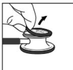
要想移除 Littmann 悬浮式可调振动膜，用拇指和食指捏住可调振动膜边缘；从听诊头上将可调振动膜向上拉出。
