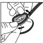
Verwijder de antikoudering om het instelbare Littmann-membraan weer te monteren. Plaats de flexibele rand van het instelbare membraan in de groef van de rand en duw de flexibele rand voorzichtig rondom en over de rand van het borststuk.
