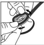
Para voltar a montar a membrana adaptável Littmann, remova a manga da campainha anti-arrepios. Introduza a borda flexível da membrana adaptável na ranhura do rebordo e enrole vagarosamente o rebordo em volta e por cima da borda da campânula.
