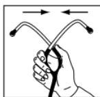
Um die Federspannung zu erhöhen, drücken Sie die Ohrbügel zusammen. Wiederholen Sie den Vorgang, bis die gewünschte Spannung eingestellt ist.
