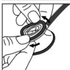
Aby ponownie zmontować membranę dwutonową Littmann, należy zdjąć „ciepłą” obwódkę lejka. Wprowadzić elastyczną krawędź membrany dwutonowej do wgłębenia w ramce i powoli nasuwać ramkę na krawędź głowicy.
