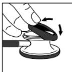
Pentru a asambla manșonul de clopot anti-răcire, așezați o parte a manșonului pe marginea capsulei și întindeți-o peste și în jurul marginii capsulei.
