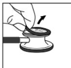
要想移除 Littmann 可調音懸浮振膜，用拇指和食指捏住可調音懸浮振膜邊緣；從聽頭上將可調音懸浮振膜向上拉出。
