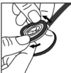
Um die einstellbare Membran von Littman wieder einzusetzen, nehmen Sie den Kälteschutzing ab. Setzen Sie den flexiblen Membranrand in die Rille des Bruststückrands und rollen ihn langsam über und um den Rand des Bruststücks.
