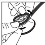
Avlägsna det icke-kylande klocköverdraget för att montera tillbaka Littman flytande membran. Sätt in den flexibla änden på det flytande membranet i kantens skära och rulla sedan membranet sakta över brööstbitens kant.
