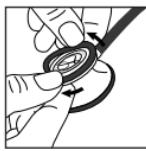
要想重新安裝 Littmann 可調音懸浮振膜，則先將防寒圈移除。將可調音懸浮振膜的柔軟邊緣插入邊緣的溝槽內，慢慢旋轉邊緣將其安裝到聽頭邊緣。
