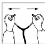
Per ridurre la tensione della molla nell'auricolare, tirare i tubicini auricolari in modo da allontanarli. Ripetere l'operazione fino a ottenere la tensione desiderata.
