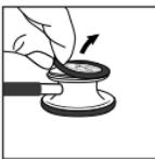
Para remover a membrana adaptável Littmann, aperte a borda da membrana com as unhas do polegar e indicador; puxe e levante a membrana da campânula.
