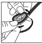
要想重新安装 Littmann 可调振动膜，将防寒圈移除。将可调振动膜的柔软边缘插入边缘的沟槽内，慢慢旋转边缘将其安装到听诊头边缘。
