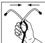
Pour réduire la tension du ressort de la lyre, saisissez les extrémités de la lyre et écartez-les doucement. Répétez l'opération jusqu'à obtention de la tension souhaitée.
