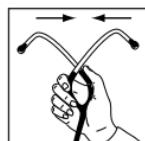
要增加耳塞中耳件簧张紧度，请挤压耳管。重复此操作直至松紧度合适。
