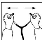
La tension de la lyre peut être ajustée si nécessaire afin de garantir un port à la fois serré et confortable dans les oreilles.
