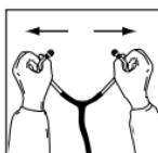
Trek de oorbuisjes uit elkaar om de veerspanning van de oorbeugel te verminderen. Herhaal dit tot u de gewenste spanning hebt bereikt.
