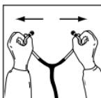
Pentru a reduce tensiunea arcului în căști, trageți de tuburile de urechi. Repetați operațiunea până când se va obține tensiunea dorită.
