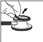
Vajutage stetoskoobi Littmann sageduspõhise membraani eemaldamiseks pöidla ja nimetissõrme küüntega membraani äärist, tömmake membraani ja eemaldage see rindkereotsikult.
