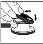
Para montar a membrana da campainha anti-arrepios, coloque um lado da manga na borda da campânula e estique-a por cima e em volta da borda da campânula.
