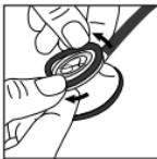
Para volver a montar la membrana de doble frecuencia Littmann, retire la goma quitafrío. Inserte el borde flexible de la membrana de doble frecuencia dentro de la ranura del aro y enrolle lentamente el aro alrededor y sobre el borde de la pieza torácica.
