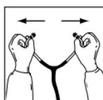
Aby se snížil tah pružiny v hlavové sadě, roztahněte od sebe ušní trubice. Opakujte, dokud nedosáhnete požadovaného tahu.
