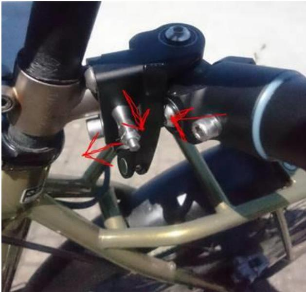
Der Schnellspanner sollte bei Verwendung des Kugelsperrbolzens nach unten geschlossen werden, so kann er auch einfacher wieder geöffnet werden.
