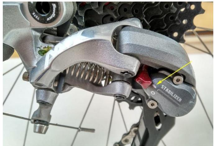
So bewirkt der Schalter eine Dämpfung des Schaltwerkksäfigs und damit eine Verringerung der Kettenbewegung für ein leiseres und stabileres Fahren. Mit dem Schalter in der **OFF-Position** erleichtert das Schaltwerk den Ein- und Ausbau des Hinterrads, indem die Schaltwerkksfeder entspannt wird.
