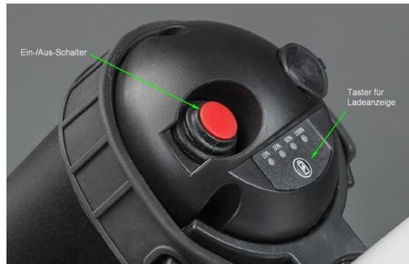
Der Akku erkennt selbst, ob er genutzt oder nicht. Sobald länger als 30 Minuten kein Strom entnommen wird, schaltet sich der Ausgang des Akkus automatisch ab. Zum Wiedereinschalten muss dann einmal der rote Druckschalter aus- und nach ca. 2 sec. wieder eingeschaltet werden!
