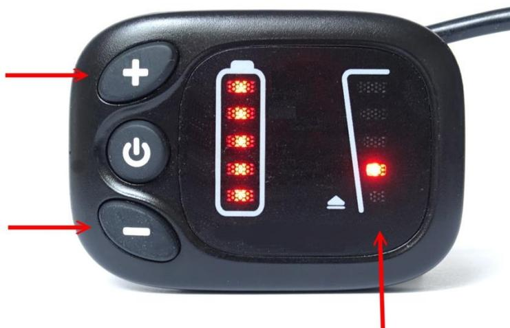
Nach dem Einschalten ist immer die Stufe "0" eingestellt und keine LED leuchtet. Das bedeutet, dass der Motor noch ausgeschaltet ist und das BEN-E-BIKE wie ein ganz normales Fahrrad fährt. Denken Sie
