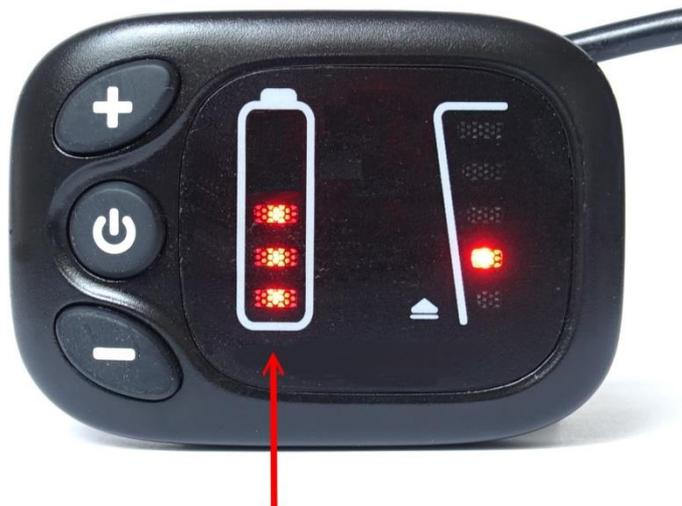
Wird der Akku durch das Fahren entladen ist, erlöschen die einzelnen LED's nach und nach. Wenn nur noch eine LED aufleuchtet, ist der Akku bereits so weit entladen, dass nur noch wenige Kilometer mit Motorunterstützung . Sobald diese letzte LED anfängt zu blinken, ist der Akku vollständig entladen und die Motorunterstützung wird deaktiviert, bis der Akku nachgeladen wird.
