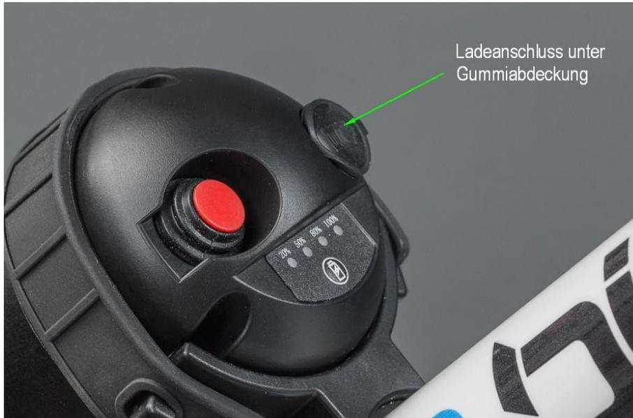
Öffnen Sie die Abdeckung vorsichtig und stecken Sie den Stecker des Ladegerätes dort ein. Schließen Sie nun das Ladegerät an das Stromnetz an.
