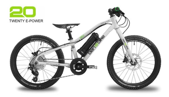
Der Einstieg in die "Ben-E-Bike" Welt - neu definiert. Das TWENTY E-POWER des Modelljahrs 2020 ist in vielen Details überarbeitet worden und bietet dank flacherem Lenkwinkel und verlängertem Radstand nun noch mehr Laufruhe und Fahrstabilität. Dazu gesellt sich die neue Motorsteuerung, die per PC-Software und USB-Interface optimal an die Bedürfnisse und Fähigkeiten des Kindes angepasst werden kann.
