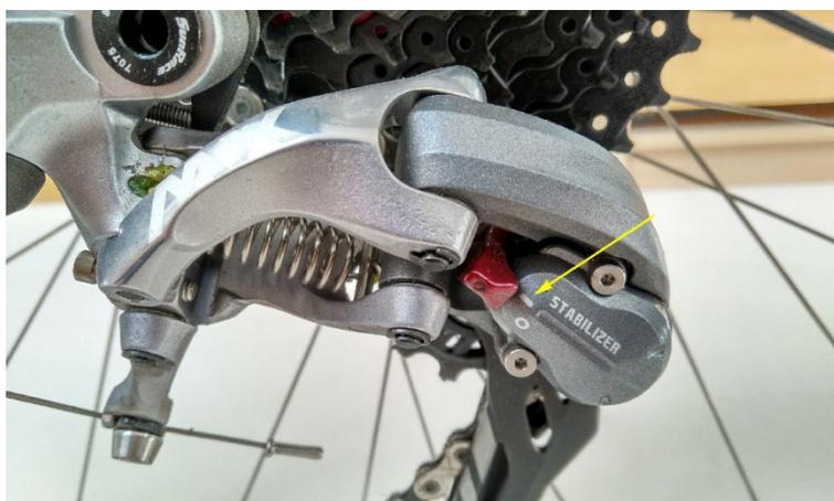
So bewirkt der Schalter eine Dämpfung des Schaltwerkträgers und damit eine Verringerung der Kettenbewegung für ein leiseres und stabileres Fahren. Mit dem Schalter in der **OFF-Position** erleichtert das Schaltwerk den Ein- und Ausbau des Hinterrads, indem die Schaltwerkfeder entspannt wird.
