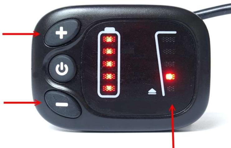
Nach dem Einschalten ist immer die Stufe "0" eingestellt und keine LED leuchtet. Das bedeutet, dass der Motor noch ausgeschaltet ist und das BEN-E-BIKE wie ein ganz normales Fahrrad fährt. Denken Sie daran, dass sich ein BEN-E-BIKE selbst ohne Motorunterstützung leichter als die meisten
