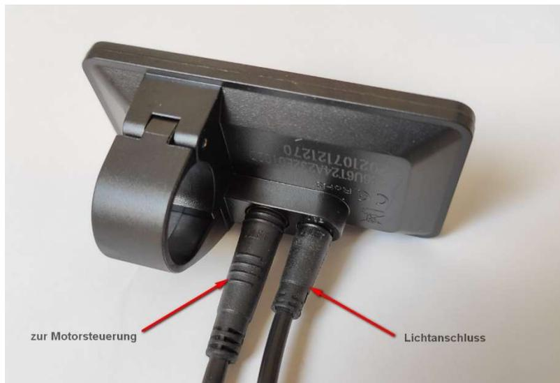
Schließen Sie nun das USB-Interface nun anstelle des Displays an das Kabel zur Motorsteuerung an.
