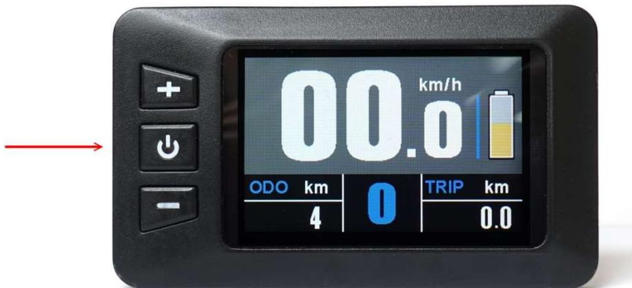
Genauso muss dieser Taster länger als 2 Sekunden gedrückt werden, um das System wieder auszuschalten. Wenn das Rad abgestellt wird und mehr als 5 Minuten weder eine Taste am Display betätigt oder die Tretkurbel gedreht wird, schaltet sich das Display automatisch ab, um den Akku zu schonen.
