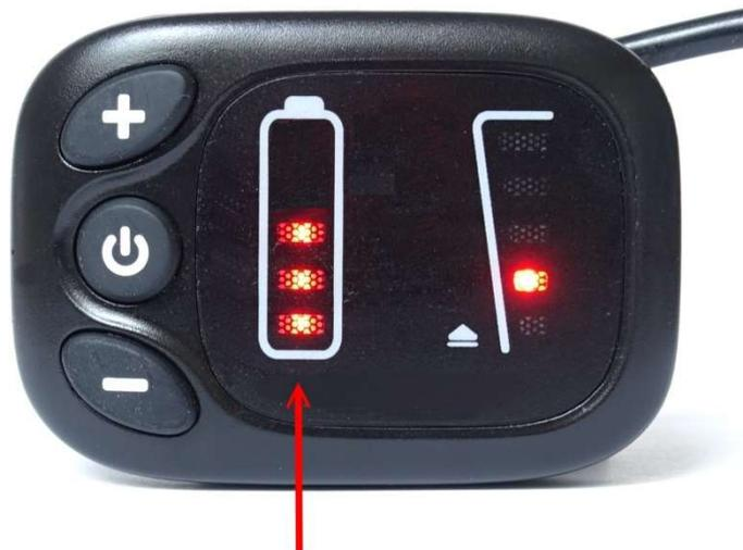
Wird der Akku durch das Fahren entladen, erlöschen die einzelnen LED's nach und nach. Wenn nur noch eine LED aufleuchtet, ist der Akku bereits so weit entladen, dass nur noch wenige Kilometer mit Motorunterstützung. Sobald diese letzte LED anfängt zu blinken, ist der Akku vollständig entladen und die Motorunterstützung wird deaktiviert, bis der Akku nachgeladen wird.
