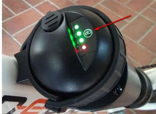
Der Akku erkennt selbst, ob er genutzt oder nicht. Sobald länger als 48 Stunden kein Strom entnommen wird, schaltet sich der Ausgang des Akkus automatisch ab. Zum Wiedereinschalten muss dann einmal der Taster wieder betätigt werden
