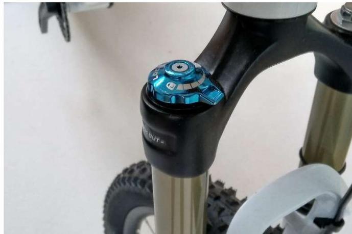
Steht der Hebel auf Linksanschlag (entgegen dem Uhrzeigersinn), so ist die Druckstufendämpfung gering. Dreht man den Hebel im Uhrzeigersinn nach rechts, wird die Dämpfung beim Einfedern immer härter bis bei komplettem Rechtsanschlag die Federgabel komplett blockiert ist ("LockOut").
