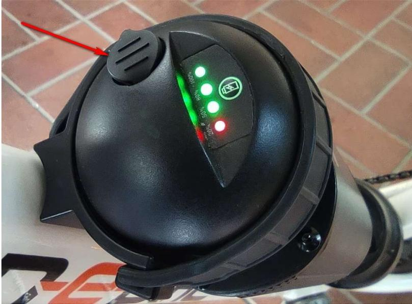
Öffnen Sie die Abdeckung vorsichtig und stecken Sie den Stecker des Ladegerätes dort ein. Schließen Sie nun das Ladegerät an das Stromnetz an.
