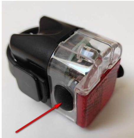
Als Zubehör können Sie aber auch ein Rücklicht erwerben, welches sich an den Lichtausgang des Controllers anschließen lässt und dann über das Display ein- bzw. ausgeschaltet werden kann. Das dazu erforderliche Anschlusskabel liegt dem Beipack des BEN-E-BIKE bei.
