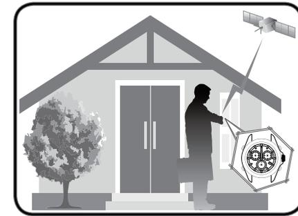
\* Im Gegensatz zu Navigationsgeräten ist diese Uhr nicht dafür ausgelegt, bei normalem Gebrauch permanent GPS-Signale von GPS-Satelliten zu empfangen. Die Uhr empfängt GPS-Signale nur im Zeitzoneanpassungsmodus und im automatischen oder manuellen Zeiteinstellungsmodus.
