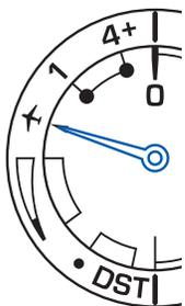
\* Wenn der Flugmodus (✈) zurückgesetzt wird, zeigt der Multi-Indikator-Zeiger den Ladezustand an.
