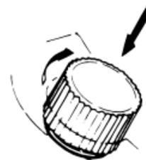
\* Drehen Sie die Krone beim Verschrauben langsam und vorsichtig. Achten Sie darauf, dass das Gewinde richtig fasst. Schrauben Sie sie nicht unter Kraftaufwendung ein, weil dadurch das Gewinde im Gehäuse beschädigt werden kann.
