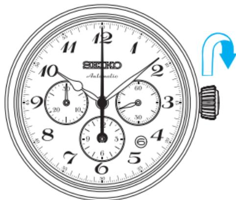
1. Drehen Sie die Krone langsam im Uhrzeigersinn (nach rechts), um die Aufzugsfeder aufzuziehen.
