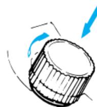
Drehen Sie die Krone unter leichtem Druck.
