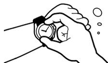
Die Bewegung des Drehrings kann unter Wasser geringfügig schwergängiger sein. Dies ist keine Störung.
