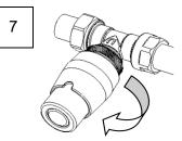
Den Kopf von HAND am Ventil festziehen. Es wird empfohlen, das Einstellungsfenster des Kopfes während der Montage gut sichtbar zu positionieren, um die richtige Einstellung des Kopfes leichter kontrollieren zu können (prüfen, ob der Kopf im gesamten Bereich 10 bis 50 arbeitet – bei Bedarf korrigieren).
