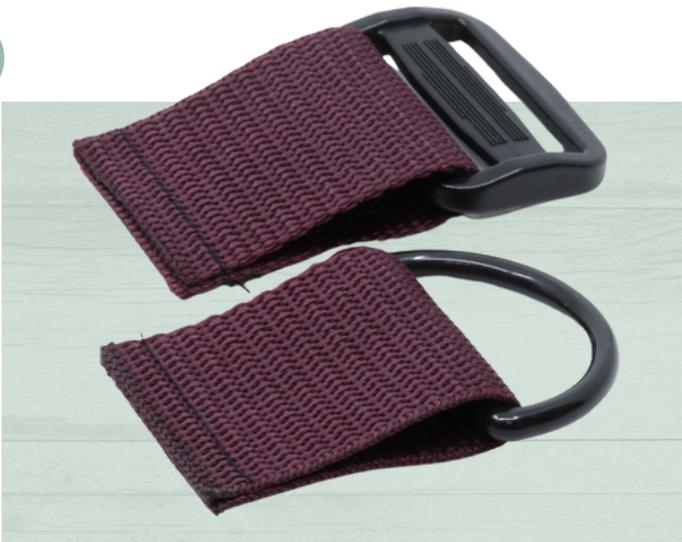
Schneide vom Gurtband 2 Stücke mit je ca. 10cm Länge ab. Fädle auf ein Stück den D-Ring, auf das andere den Schieber, wie auf dem Bild gezeigt. Fixiere beide Stücke mit einer Naht knapp an der Kante. Die Enden kannst du mit einem Feuerzeug vorsichtig verschmelzen, damit sie nicht ausfransen.
