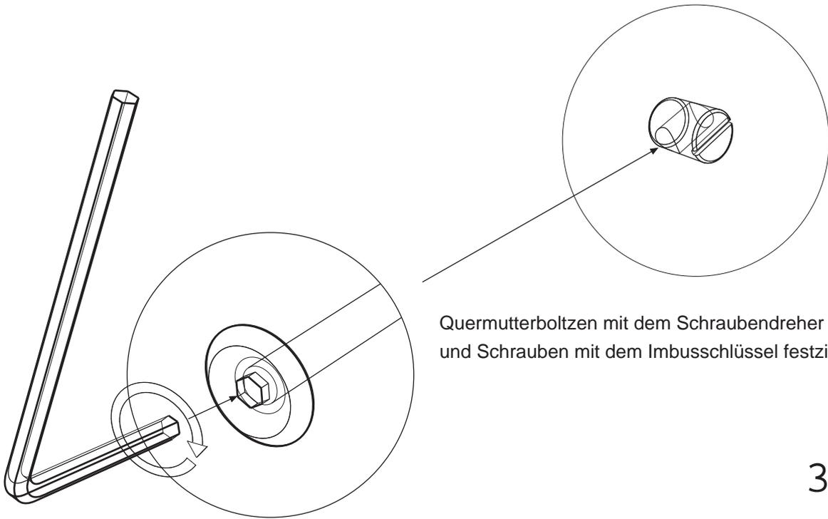
Quermutterbolzen mit dem Schraubendreher ausrichten und Schrauben mit dem Imbusschlüssel festziehen.
