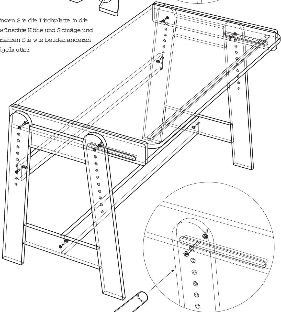
Schrauben und Muttern festziehen und - wenn gewünscht - Rollstopp für die Schräge einlegen - fertig!
